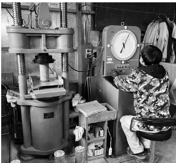
セメントの強度検査
